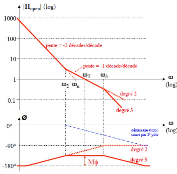
En acceptant de réduire  $M\phi$  à  $45^\circ$ , ce qui est encore correct pour une PLL, il faut :
