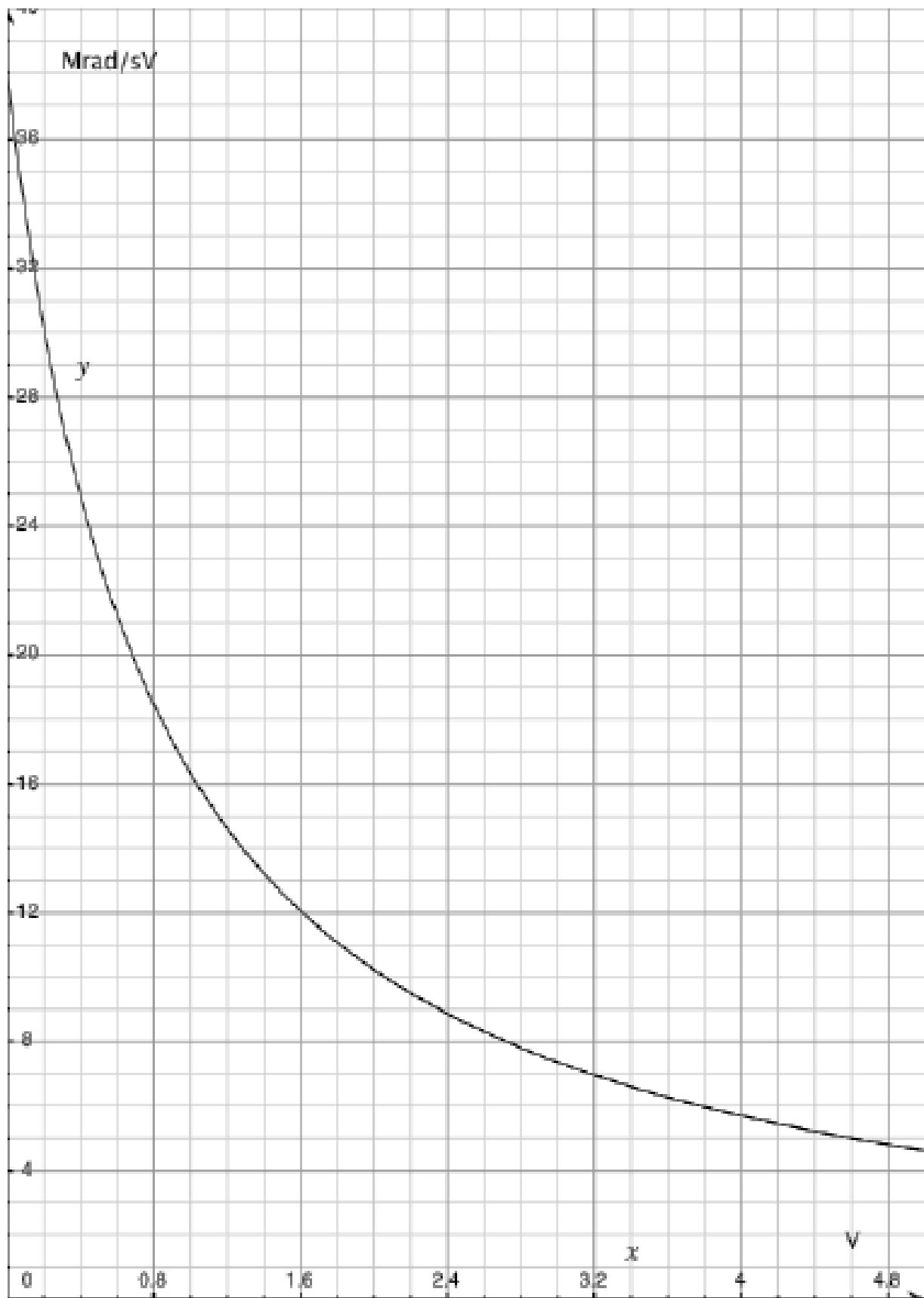
"Gain" du VCO  $K_{VCO}$  en Mrad/s/V en fonction de la tension de commande  $V_0$  en Volts
